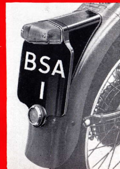
Den nya anordningen för bakre nummerplåt och inbyggd kombinerad stopp- och baklampa är både praktisk och har tilltalande utseende.
