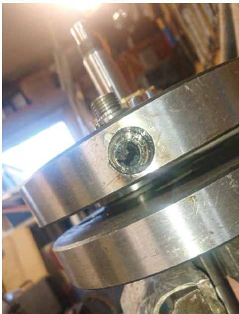
Lite pill med en tunn skruvmejsel för att se hur djup proppen var.
