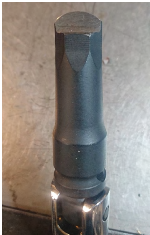
En 17 mm insex krafthylsa med 1/2" fäste från Biltema (Art 71-162, 45:-), modifierades för att passa tätt i skruvspåret för A65:ans plugg till centrifugalfiltret.
