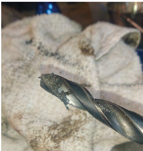
I stort sett hela proppen kunde fås ut genom att en borr i passande diameter skruvades in för hand och drog med sig "proppen" ut.
